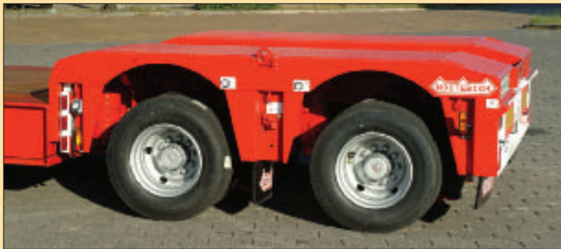
Het nieuwe superkorte assenstel van Nooteboom is zowel voor als achter afgeschuind en de brede sleuf bleef behouden.
