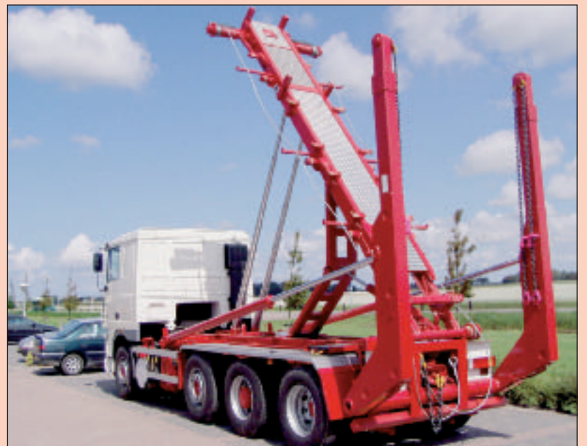
Nieuw is het dealerschap van de HTS kabel- en portaalarmafzetsystemen. Op de foto een speciale opbouw voor de firma Baru uit Stompeters, opgebouwd op een DAF XF95, 8x4. De opbouw bestaat uit een 30 tons HTS kabelsysteem en een 8 tons uitschuifbaar HTS portaalarmsysteem.
