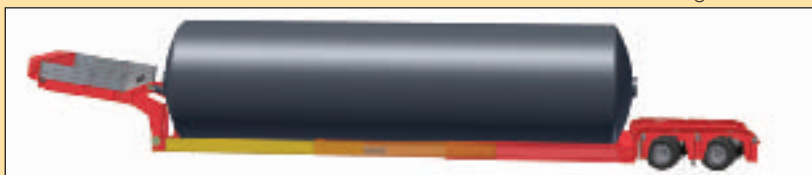
In combinatie met de nieuwe, kortere beweegnek en het eveneens superkorte assenstel is ruim 1 meter lading meer mee te nemen.
