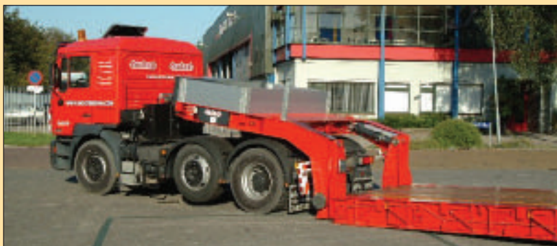
De nieuwe nek laat onbelemmerd heffen en zakken van de lading toe.
