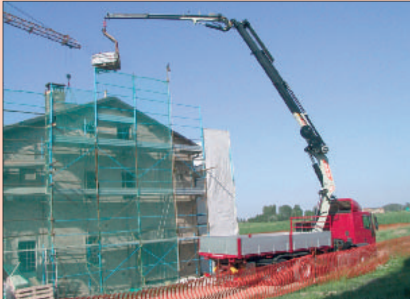
Populair is deze 39024 PM-kraan met dubbele kniehevel. De kraan is vier keer hydraulisch uitschuifbaar en uitgevoerd met jib, waardoor die uitermate geschikt is als bouw- of dakdekkerskraan.
