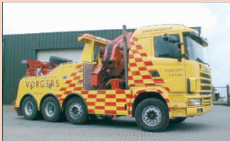
Omars levert ook zware bergingsinstallaties in de capaciteiten van 10 tot 30 ton. Hier een type 100T met twee hydraulische lieren en zware bergingskraan voor de firma Volgers uit Borne.
