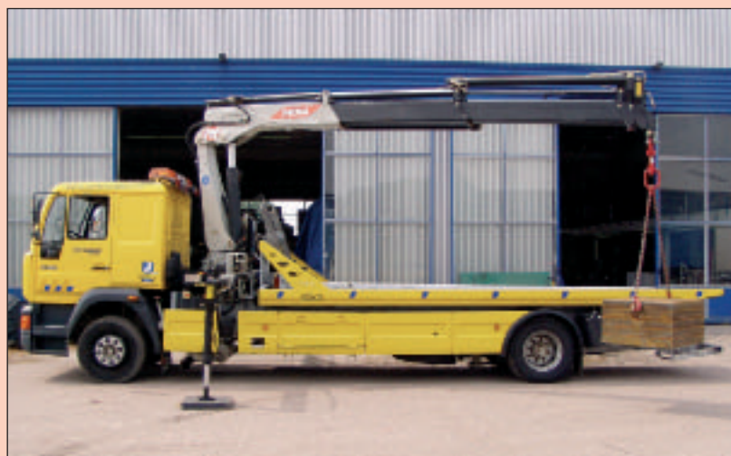
Het Italiaanse Omars Spa levert onder meer dit 6 tons schuifplateau voor autotransport. Dit voertuig voor Reinders uit Weerselo is tevens voorzien van een PM 14014 Lift-Away kraan die speciaal geschikt is voor het opnemen van personenwagens door middel van een juk.
