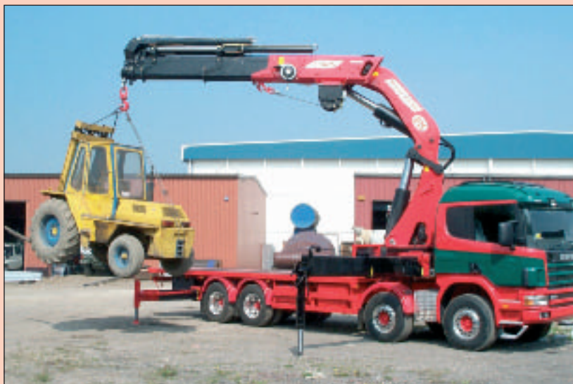
Een zwaargewicht is deze PM 75026-kraan, die ook leverbaar is als 80 tonmeter-kraan.
