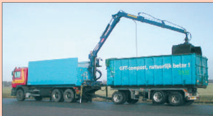
Deze Foresteri 2012-T kraan wordt door Overdevest uit Breezand ingezet voor GFT-compost. De kraan is twee keer hydraulisch uitschuifbaar en kent een grote rotatiesnelheid.
