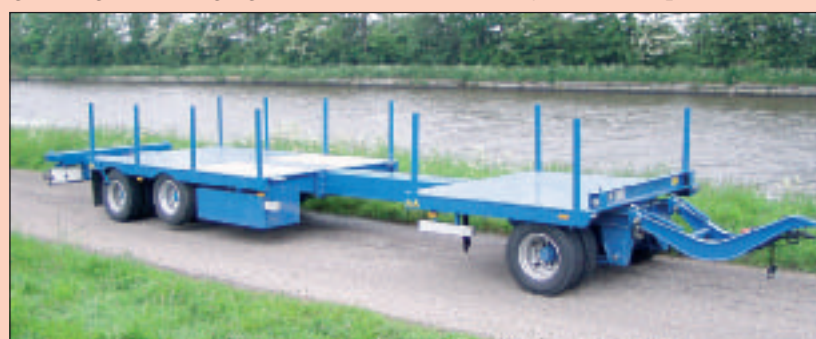
Ligthart maakt veel maatwerk opleggers, aanhangers en diepladers, zoals deze drie-assige aanhangwagen voor KTW Zaandam voor het transport van bouwketen. De aanhanger is voor en achter uitschuifbaar uitgevoerd, heeft een vloerhoogte van 88 cm en een GVW van 30 ton.
