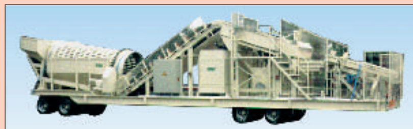
Voor deze stenenmachine, waarin met een shovel straatstenen geschept kunnen worden, waarna die door de machine worden schoongemaakt en automatisch op pallets in iedere gewenste legvorm worden gestapeld, bouwde Ligthart de aanhangwagen in buitenwettelijke maten.
